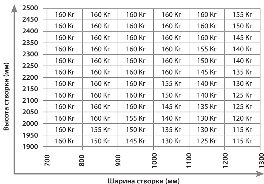
Максимальный вес дверной створки при использовании 2х петель „Rollenband AT“
